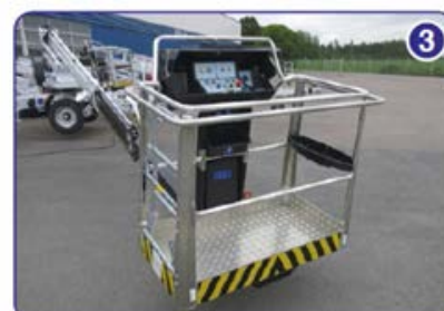
Romslig arbeidskurv kapasitet 215 kg
