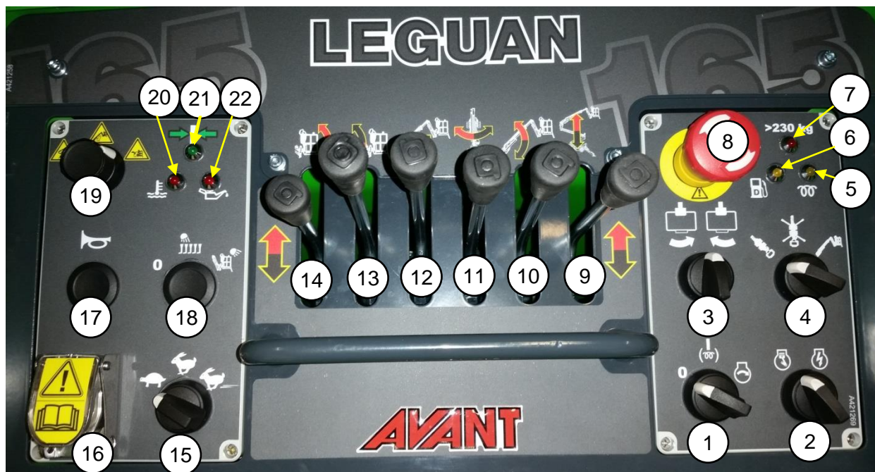
Figur 5. Spaker, brytere og knapper på øvre kontrollpanel
